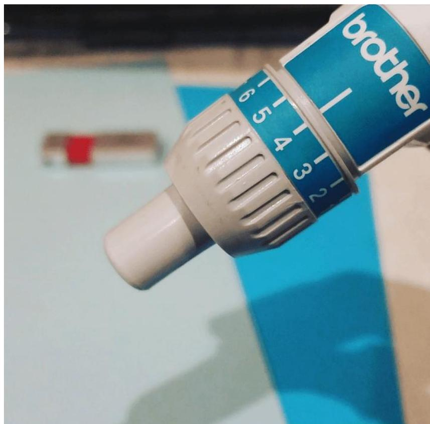
A la fin du traçage, nous pouvons lancer la découpe en plaçant le support de lame dans la scan N Cut
