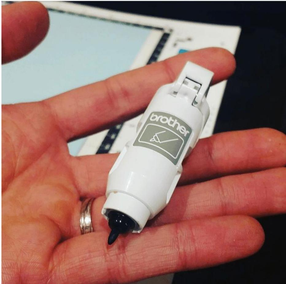
Préparez votre support à stylo et insérez le dans la scan n cut à la place de la lame.
